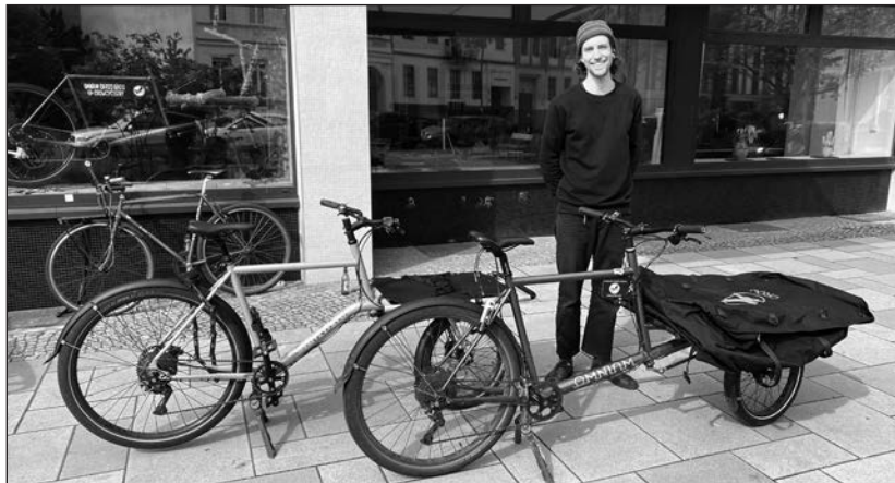
GRÖSSENVERGLEICH: Mit kürzerem Radstand ist das Rad wendiger, während der größere Radstand mehr Zuladung ermöglicht. Foto: rsp
