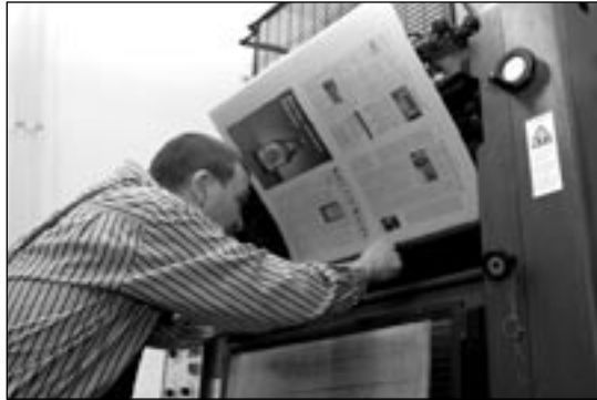
DRUCKER ULI SATTLER beim Einspannen der Druckplatte. Trotz Schnellspannvorrichtung ist die Benutzung eines Schraubenschlüssels obligatorisch.
