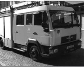
Ihr Schmuckstück und Hauptarbeitsmittel ist ein Lösch- und Hilfsfahrzeug (LHF) 16/12, das speziell für die Großstadt entwickelt wurde. Es hat einen Löschwassertank mit 1200 Litern, Pumpe, Schaummittel und jede Menge technische Geräte an Bord. Das knallrote Feuerwehrauto ist eine der Hauptattraktionen dieses Straßenfestes. Kinder können sich die Technik erklären lassen und auch darin herumklettern.
